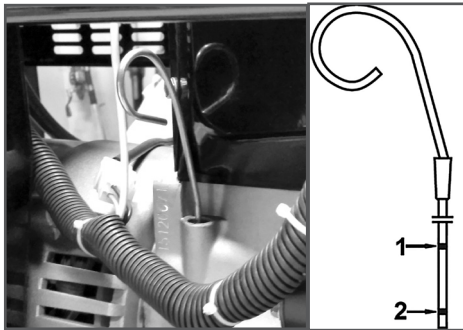
Рис. 8 Проверка уровня масла в картере
